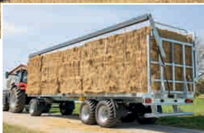
DPW 210 Ultra con fissaggio carico chiuso, apertura a scelta a destra o a sinistra.
