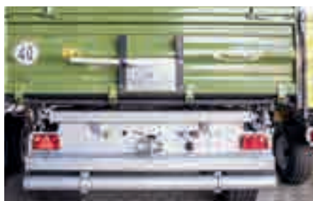
Versione da 40 km/h con protezione antincastro e parafranghi
