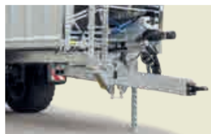
Dispositivo di traino con sospensione idraulica continua per aggancio basso
