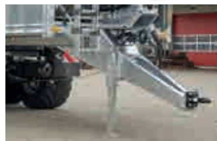
Barra di traino senza sospensioni, ruotabile per aggancio alto e basso
