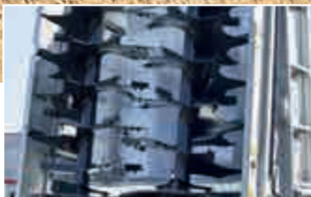
I rulli fresa tritano il prodotto da spandere e assicurano un materiale omogeneo.
