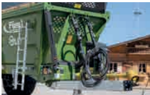
Timone di traino con sospensione idraulica. L'altezza di aggancio può essere regolata comodamente.
