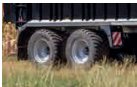
Varianti di pneumatici fino a 800/45 R 22,5" o, a scelta, 710/50 R 30,5"
