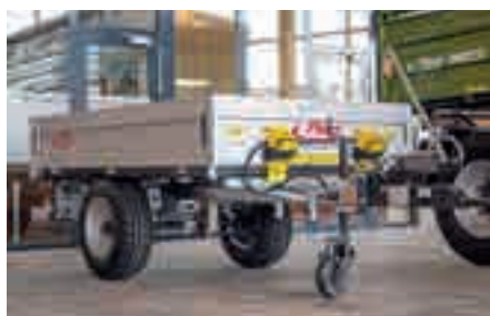
Super leggero: L'EDK 25 con sovrasponde laterali in alluminio e alzata per fogliame
