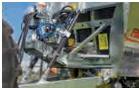
Sospensione idraulica del timone, massimo comfort di marcia
