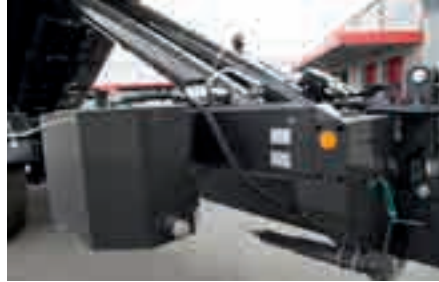
Impianto idraulico di bordo 60 litri (opzionale 90 litri) azionato tramite la trasmissione della presa di forza con pompa idraulica e serbatoio dell'olio
