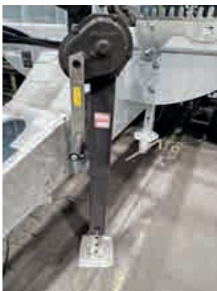
Piede di appoggio a 2 velocità
