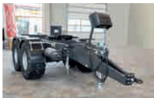
Dolly Tandem con carico ralla 17 t e massa totale 20 t
