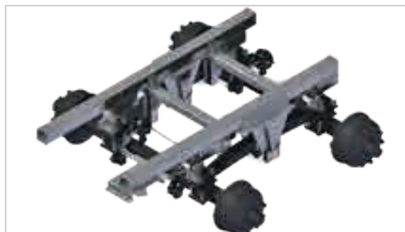
Gruppo Tandem Titan per una compensazione ottimale del terreno, non richiede lubrificazione e manutenzione.
