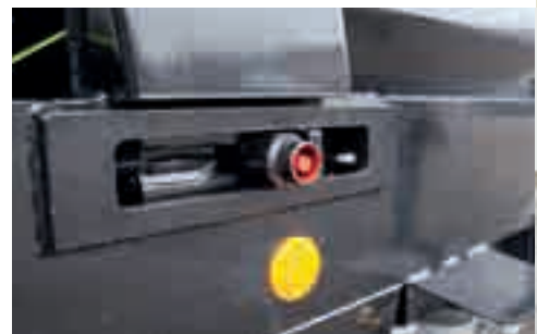
Pignoni catena facilmente accessibili e lubrificabili su entrambi i lati attraverso l'albero
