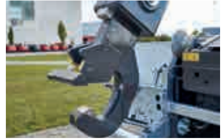
Gancio di alloggiamento forgiato facilmente sostituibile
