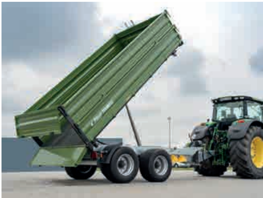
Versione portello ghiaia con sponda posteriore idraulica da 500 mm.
