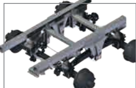
Gruppo Tandem Titan per una compensazione ottimale del terreno.
