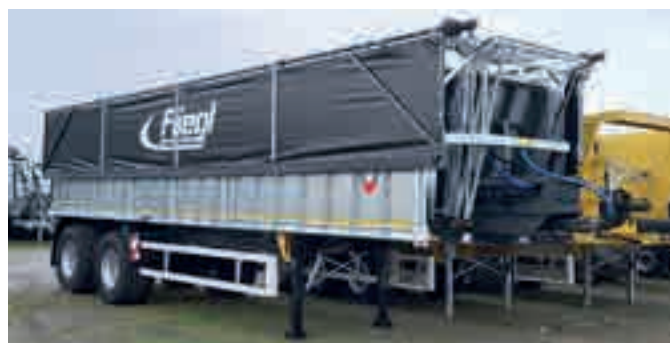
TOPLIFT: Le due metà del telone possono essere aperte e chiuse in pochissimo tempo
