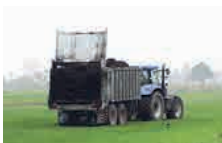
Gruppo di spandimento »Profi V2n« Per carri a spinta con altezza cassone 1500 mm
