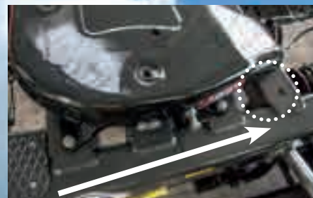
Regolazione meccanica della piastra ralla per dolly monoasse e tandem
