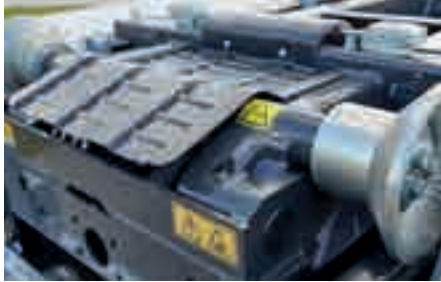
I grandi rulli di scarramento in acciaio colato ( \varnothing 310 mm) con un'ampia inclinazione di centraggio facilitano il caricamento del container.
