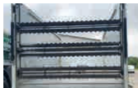
Rullo dosatore con 3 rulli fresa orizzontali
