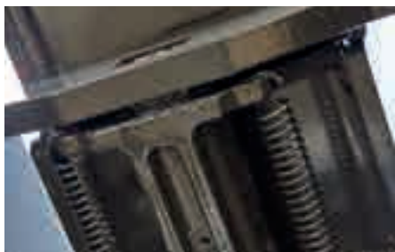
Blocco automatico del gancio durante l'inclinazione
